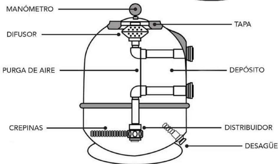
Velocidad Filtración: 50 m<sup>3</sup>/h/m<sup>2</sup>
